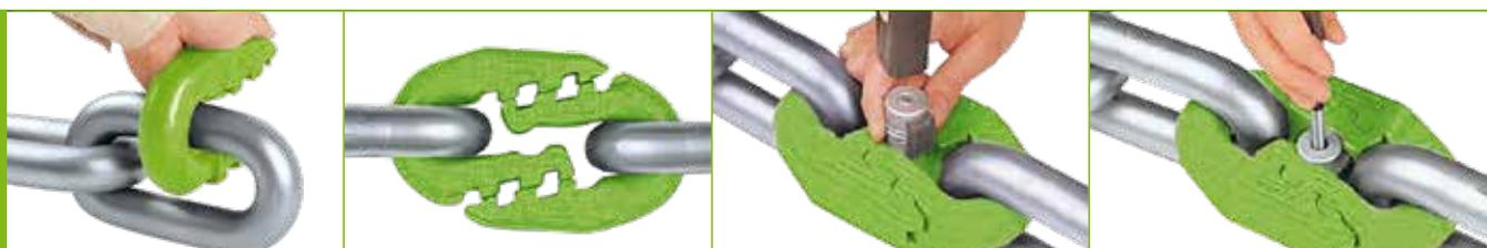
Плоский замок DOMINATOR может устанавливаться на цепь как в горизонтальном, так и в вертикальном положении. Его применение в соответствии с требованиями норм DIN 22252 возможно как в угольных стругах, так и в горизонтальном положении в качестве ремонтного замка при соединении плоских цепей по DIN 22255.
